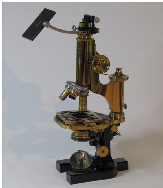
jo, prisma y filtros. El prisma se adapta al ocular en el tubo del microscopio mediante un tornillo. El prisma envía la imagen al espejo sujeto por un brazo articulado, proyectando así la imagen y facilitando que la muestra observada pueda ser dibujada sobre el papel.
