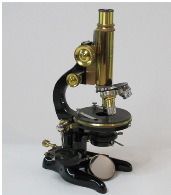
Microscopio petrográfico para cristalografía (Colección de Instrumentos Científicos Históricos del MNCN, nº 2T054. Foto: Jorge Pina)
